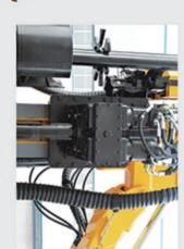
双摆线马达回转装置,回转扭矩大、不容易卡钻,同时 可以根据不同岩层调节回转速度。进口回转密封件,密 封性好、寿命长。
